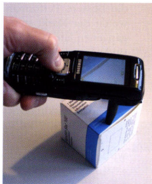
Das System von Alpvision beruht auf tausenden winzigen Punkten, die Daten auf gesicherte Weise kodieren.
