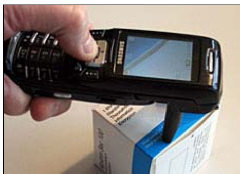
Lo scanner messo a punto dalla ditta Alpvision per rilevare i codici invisibili a occhio nudo (foto Alpvision)
